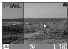
Belichten Sie die erste Aufnahme. Etwa ein Drittel der ersten Aufnahme wird als halbtransparentes Bild über dem Livebild auf dem Monitor eingeblendet. Wenn Sie die Kamera von links nach rechts schwenken, wird das rechte Drittel der vorherigen Aufnahme am linken Rand des Monitors eingeblendet.
