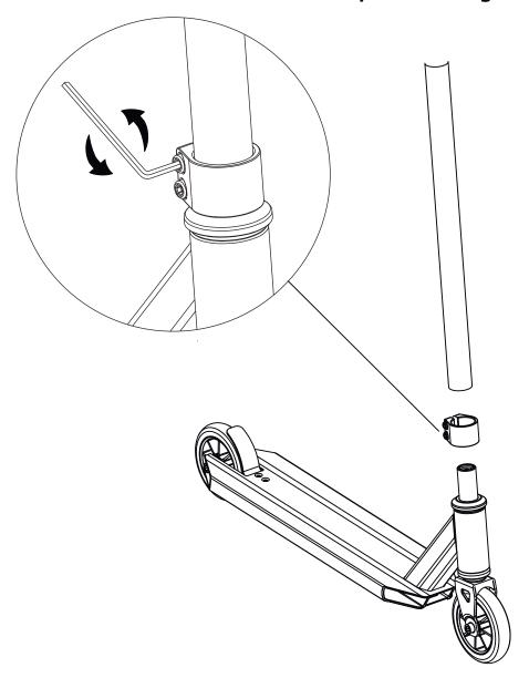
Schieben Sie die Klemme auf das untere Ende der Lenkstange. Stecken Sie die Lenkstange auf die Gabel auf. Richten Sie die Lenkstange im 90° Winkel zum Deck aus und zentrieren die Klemme (offenes Ende zeigt zum Deck hin). Ziehen Sie die Schrauben (M6x20) der Klemme mit dem mitgelieferten 5mm Inbusschlüssel an. Überprüfen Sie alle Schrauben auf einen festen Sitz.
