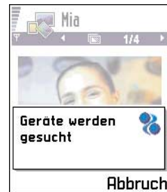
Abb. 3 Beim Senden eines Bildes über Bluetooth beginnt das Telefon, nach Geräten zu suchen.
