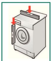
Ausrichtung der Waschmaschine mit Wasserwaage überprüfen, evtl. korrigieren.
