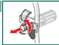
3. Alle 4 Transportsicherungen komplett entfernen (jeweils Schraube zusammen mit Hülse) und die Netzleitung aus den Halterungen nehmen.
