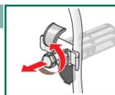
3. Alle 4 Transportsicherungen komplett entfernen (jeweils Schraube zusammen mit Hülse) und die Netzleitung aus den Halterungen nehmen.
