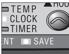
J: Wenn die Kontroll-Lampe SAVE aufleuchtet, schaltet sich der Kaminofen automatisch ein und aus, um innerhalb eines bestimmten Temperaturbereiches zu bleiben.
