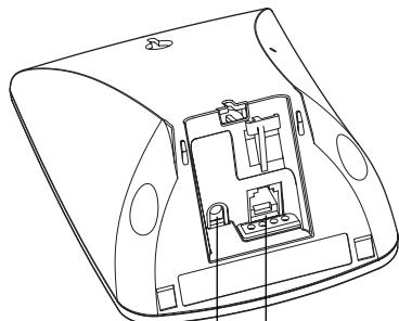
Anschlussbuchse für Netzkabel ②
