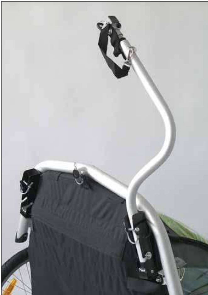
Korrekt montierte Deichsel, Ansicht von unten.
