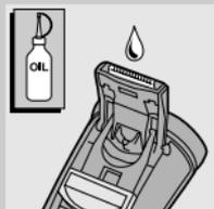
**3** Lubrificate i dentini del tagliabasette ogni sei mesi, utilizzando una goccia di olio per macchina per cucire.
