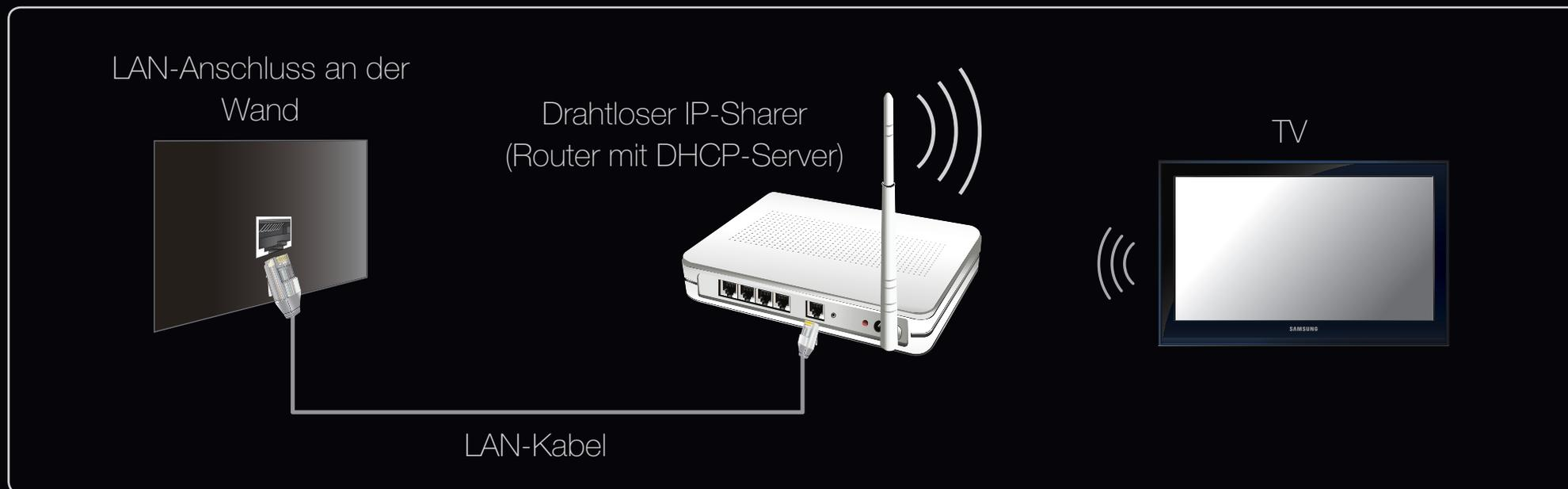
Der Samsung WLAN-Adapter unterstützt die Kommunikationsprotokolle IEEE 802,11a/b/g und N. Samsung empfiehlt, IEEE 802,11 n zu verwenden. Wenn Sie Video über die IEEE 802,11b/g-Verbindung anzeigen, wird das Videobild möglicherweise nicht ohne Unterbrechungen angezeigt.
