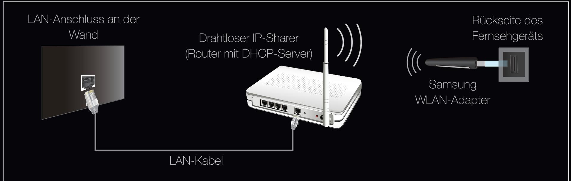
Der Samsung WLAN-Adapter wird bei ausgewählten Einzelhändlern, E-Commerce-Sites und unter [samsungparts.com](http://samsungparts.com) angeboten. Der Samsung WLAN-Adapter unterstützt die Kommunikationsprotokolle IEEE 802,11 a/b/g und n. Samsung empfiehlt, IEEE 802,11 n zu verwenden. Wenn Sie Video über die IEEE 802.11b/g-Verbindung anzeigen, wird das Videobild möglicherweise nicht ohne Unterbrechungen angezeigt.
