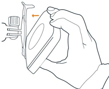
1. Appoggiate il dispositivo di navigazione sul dente inferiore del supporto. (Vedere figura)
