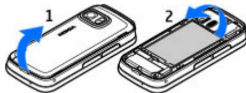
Rimuovere la cover posteriore sollevandola dalla parte inferiore del dispositivo.
