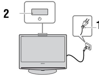
**1** Kytke televisio verkkopistorasiaan (220-240V AC, 50Hz).
