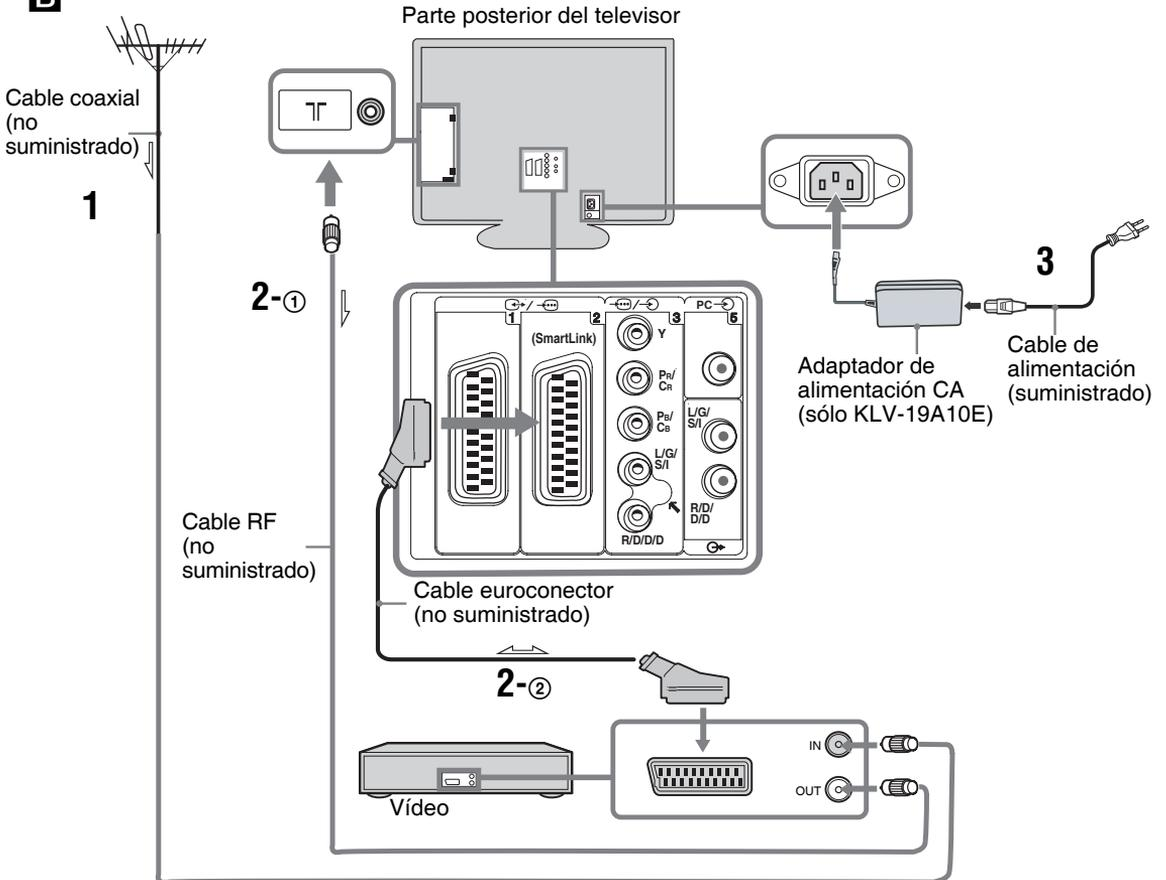
**1** Conecte la antena mediante el cable coaxial.
