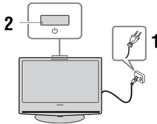
**1** Conecte el televisor a la toma de corriente (220-240V CA, 50Hz).
