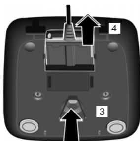
Si le connecteur du chargeur doit de nouveau être retiré, appuyer sur le bouton de déverrouillage **3** et retirer le connecteur **4**.
