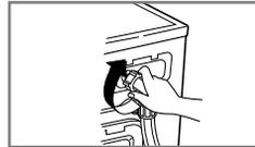
4. Den Wasserzulaufschlauch aufschrauben.
