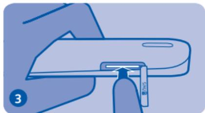
Inserire la memory card fino a bloccarla in posizione. Chiudere l'alloggiamento.
