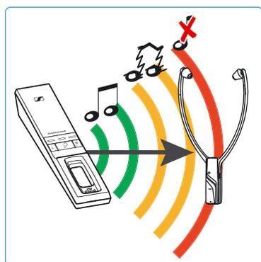
La portée de l'émetteur varie beaucoup selon les éléments de l'environnement : épaisseur des murs, matériau des murs, etc. Si le récepteur stéthoscopique quitte la portée de l'émetteur, la qualité sonore se détériore, puis la connexion est interrompue. Vous entendez des bips d'alerte dans le récepteur stéthoscopique et la LED *État récepteur* clignote en vert (ou rouge si l'accu est presque déchargé).
