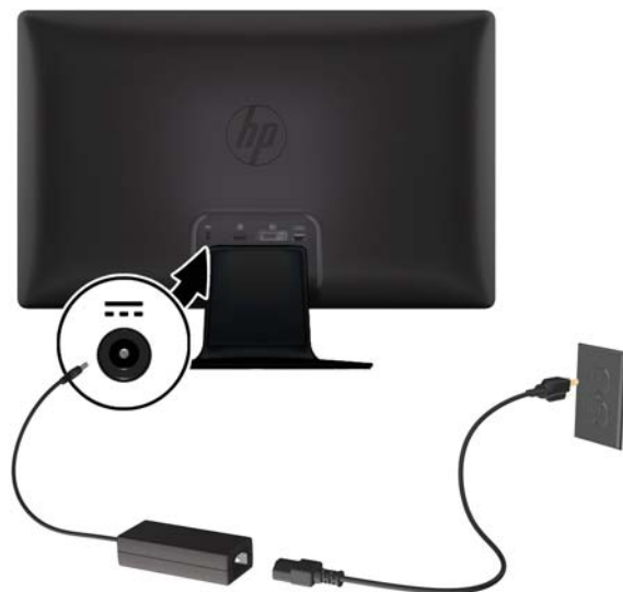
Figure 3-6 Branchement du cordon d'alimentation
