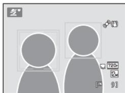
Drücken Sie den Auslöser bis zum ersten Druckpunkt, um den Autofokus und die Belichtungsmessung zu aktivieren. Sobald die Scharfstellung erfolgt ist, leuchtet das aktive Fokussmessfeld grün.
