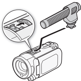
Esempio: montaggio del microfono direttivo stereo DM-100 opzionale.
