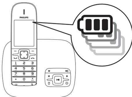
L'icône de batteries indique le niveau actuel de charge des batteries.
