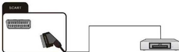
1. Verbinden Sie das externe Gerät mit der SCART-Buchse (11). Das erforderliche SCART-Kabel gehört nicht zum Lieferumfang.
