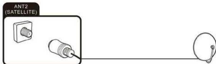
1. Verbinden Sie den Stecker am Ende des Satellitenantennenkabels mit der Buchse ANT 2 SATELLITE (9).
