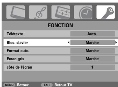
Lorsque la fonction **Blocage du clavier** est **activée**, un rappel s'affichera lorsque vous appuierez sur l'une quelconque des touches du panneau supérieur. Une fois le téléviseur éteint, il ne pourra être rallumé QU'en utilisant la télécommande.
