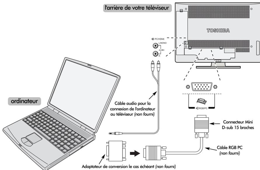
Connectez le câble d'ordinateur de l'ordinateur à la borne PC à l'arrière du téléviseur.
