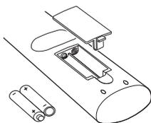
Retirez le cache arrière pour ouvrir le compartiment des piles et assurez-vous de bien respecter les polarités. Des types de piles appropriés pour cette télécommande sont AAA, IEC R03 1,5 V.
