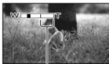
Il lato destro della barra indica il fattore di ingrandimento dello zoom digitale. L'area dello zoom viene visualizzata quando si seleziona [300x].
