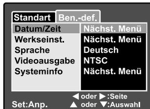
4. Wählen Sie mit den Tasten ◀/▶ das entsprechende Feld aus und ändern den jeweiligen Wert des Datums und der Uhrzeit mit den Tasten ▲/▼.
