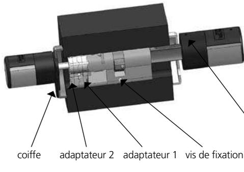
Représentation schématique d'un cylindre monté y compris les deux adaptateurs.
