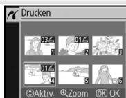
Falls Sie mehrere Abzüge des Bildes drucken möchten, erhöhen Sie die Anzahl entsprechend (bis zu 99). Um ein Bild aus der Druckauswahl herauszunehmen, drücken Sie den Multifunktionswähler so lange unten, bis als Anzahl wieder »0« eingestellt ist (die Null wird nicht angezeigt). Wiederholen Sie die Schritte 1 bis 3, um weitere Bilder auszuwählen.
