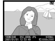
Drehen Sie das Einstellrad oder drücken Sie den Multifunktionswähler links oder rechts, um weitere Aufnahmen einzublenden.
