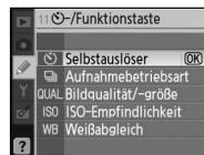
Bei allen Einstellungen außer »**Selbstausslöser**« (Standardvorgabe) wird in den Aufnahmeinformationen das Symbol links neben der Option angezeigt, die mit Hilfe der **Fn**-Taste und des Einstellrads eingestellt werden kann (Nur bei Anzeige »Klassisch«; ☺ 81).
