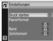
Blenden Sie die Druckoptionen ein. Wählen Sie das Papierformat, ob Sie mit oder ohne Rand drucken möchten und ob ein Zeitstempel in die Bilder eingedruckt werden soll (Einstellungsmöglichkeiten siehe Seite 59). Markieren Sie die Option »**Druck starten**« und drücken Sie die Taste **OK**, um den Druckvorgang zu starten. Nach Abschluss des Druckvorgangs wird wieder das PictBridge-Menü eingeblendet.
