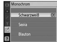
Bei Auswahl von »**Sepia**« bzw. »**Blauton**« wird eine Vorschau des ausgewählten Bildes angezeigt. Drücken Sie den Multifunktionswähler oben, um die Farbsättigung zu erhöhen, bzw. unten, um sie zu verringern. Drücken Sie **OK**, um eine Monochromkopie zu erstellen und zur Einzelbildwiedergabe zurückzukehren.
