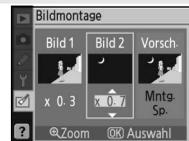
7 Drücken Sie den Multifunktionswähler links oder rechts, um die Spalte »**Vorsch.**« zu markieren. Drücken Sie den Multifunktionswähler oben oder unten, um eine der folgenden Optionen zu markieren, und drücken Sie dann die Taste **OK**.
