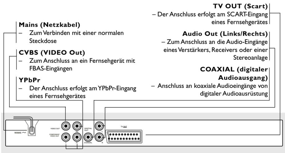
**Achtung: Berühren Sie niemals die Stifte in den Buchsen auf der Rückseite des Geräts. Elektrostatische Entladungen können zu irreparablen Schäden am Gerät führen.**
