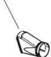
Buse d'air sortant (1 unité)
