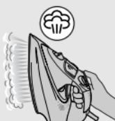
**1** La funzione vapore verticale può essere usata quando si tiene il ferro in posizione verticale, per eliminare le pieghe da capi appesi, tende ecc.
