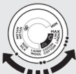
**2** Selezionate la temperatura di stiratura consigliata (vedere “Predisposizione dell'apparecchio”, sezione “Selezione della temperatura e regolazione del vapore”).
