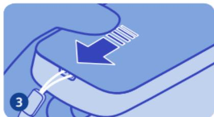
Faites glisser la façade arrière vers le bas jusqu'à ce qu'elle se verrouille en émettant un déclic.
