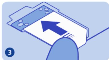
Glissez la carte SIM sous le logement avec la zone de contact orientée vers le bas. Voir ➔ 2 dans "Instructions propres à la fonctionnalité".
