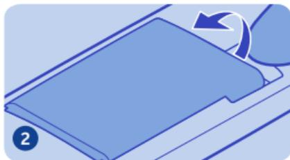
Si la batterie est insérée dans le téléphone, soulevez-la pour la retirer.
