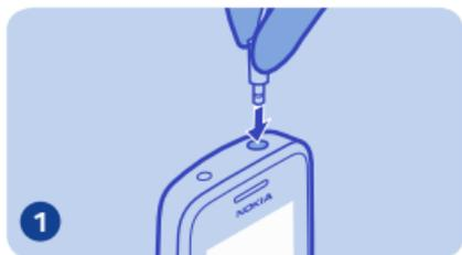
Connectez un kit oreillette compatible. Il fait office d'antenne.
