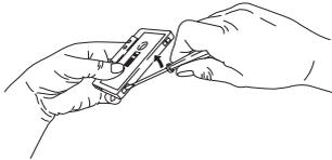
Bei bespielten Kassetten der Industrie sind diese Zungen bereits entfernt. Ein nachträgliches Löschen ist trotzdem möglich, wenn Sie vor einer Neuaufnahme die Öffnung mit Plastik-Klebeband überkleben.
