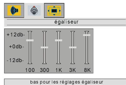
Appuyez sur le bouton “▼” pour sélectionner la première bande de fréquence. Appuyez sur le bouton “◀” / “▶” pour sélectionner les autres bandes de fréquence. La bande sélectionnée peut être réglée en pressant le bouton “▲” / “▼”.
