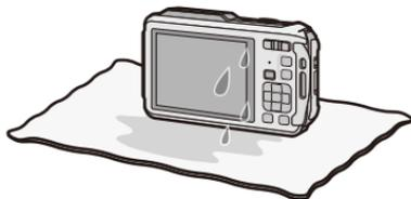
**4 Controllare che non vi siano goccioline d'acqua, aprire lo sportello laterale e rimuovere le medesime o la sabbia usando un panno asciutto e morbido.**
