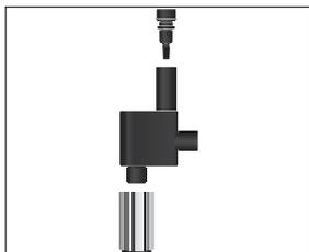
Per fare in modo che l'ugello per microschiuma funzioni correttamente e per motivi igienici, è obbligatorio scomporlo e sciacquarlo **giornalmente** se è stato utilizzato per preparare il latte. L'IMPRESSA non segnala la necessità di scomporre e sciacquare l'ugello per microschiuma.
