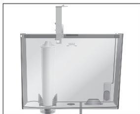
**i** Il filtro ha un'efficacia di due mesi. Impostare la durata del filtro tramite l'apposito datario sul supporto della cartuccia nel serbatoio dell'acqua.
