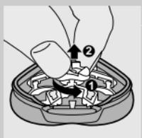
**1** Öffnen Sie die Schereinheit, drehen Sie das Rädchen gegen den Uhrzeigersinn (1) und entnehmen Sie den Scherkopfhalter (2).
