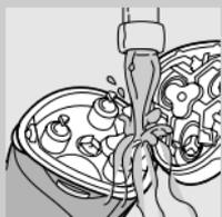
**3** Reinigen Sie Schereinheit und Bartfangkammer, indem sie beide eine Weile unter heißem Wasser ausspülen.
