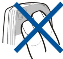
Votre téléphone est muni d'une antenne intégrée. Comme pour tout appareil de transmission par fréquences radioélectriques, ne touchez pas inutilement l'antenne lorsque le téléphone est sous tension. Tout contact avec l'antenne altère la qualité de la communication et risque de faire fonctionner le téléphone à une puissance plus élevée que nécessaire. Évitez de toucher cette zone pendant un appel pour optimiser les performances ainsi que la durée de communication du téléphone.
