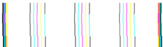
Esempio di un modello di allineamento errato Le righe sono irregolari - eseguire l'allineamento della stampante. Se il problema persiste, contattare HP. Per ulteriori informazioni su come contattare HP, vedere Assistenza HP .
