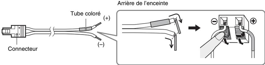
Lors du raccordement à l'appareil, insérez le connecteur jusqu'à ce qu'il émette un déclic.
