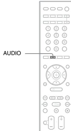
**Appuyez plusieurs fois sur AUDIO jusqu'à ce que le signal souhaité apparaisse sur l'affichage du panneau frontal.**
