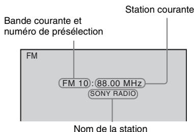
**1 Appuyez plusieurs fois sur FUNCTION +/- jusqu'à ce que l'indication « TUNER FM » ou « TUNER AM » apparaisse sur l'affichage du panneau frontal.**
