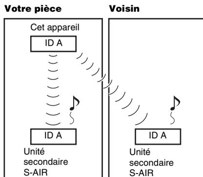
Après le jumelage, la transmission du son s'établit entre l'appareil jumelé et le(s) unité(s) secondaire(s) S-AIR uniquement.
