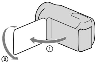
Aprire il pannello LCD di 90 gradi rispetto alla videocamera (①), quindi ruotarlo di
