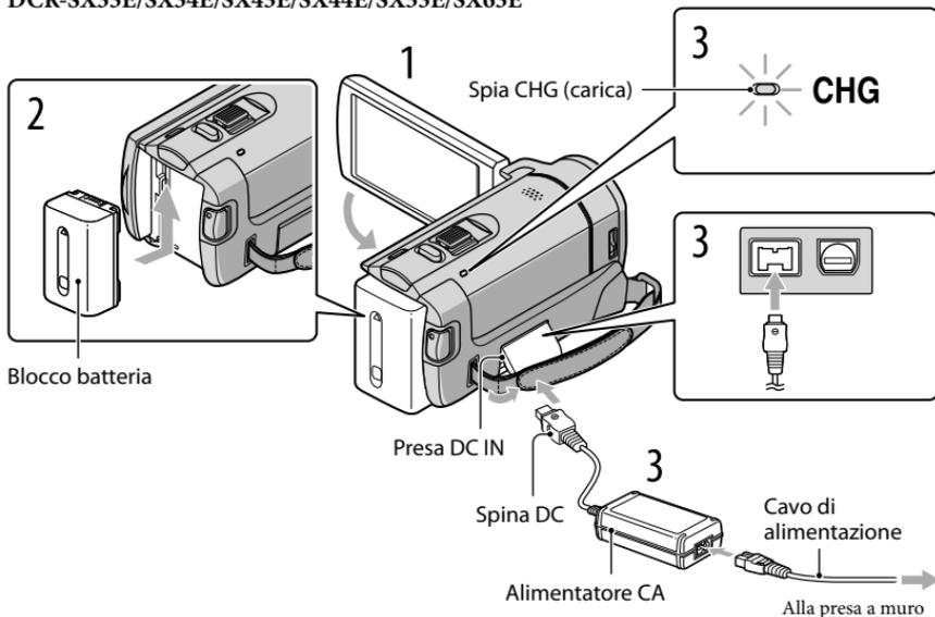
È possibile caricare il blocco batteria "InfoLITHIUM" (serie V) dopo averlo inserito nella videocamera.
