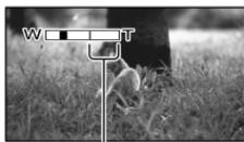
Il lato destro della barra indica il fattore di ingrandimento dello zoom digitale. L'area dello zoom viene visualizzata se si seleziona il livello di zoom.
