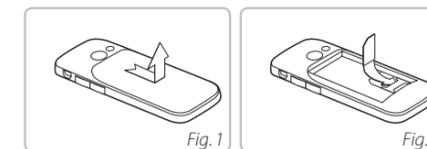
**Fig. 1:** rimuovere il coperchio della batteria
