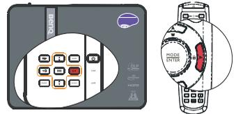
Um die Sperre des Tastenfelds aufzuheben, drücken Sie für 3 Sekunden auf **▶/🔒** auf dem Projektor oder auf der Fernbedienung.
