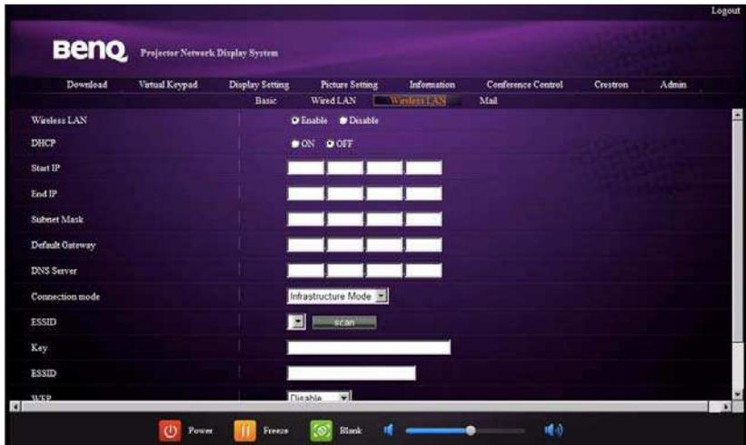
Die maximale Länge der SSID beträgt 16 Bytes. Bitte benutzen Sie eine andere SSID, wenn mehr als zwei Projektoren über WLAN verbunden sind.
