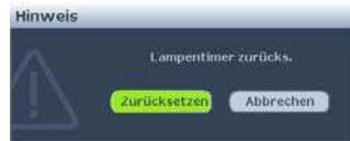
Drücken Sie auf **▼**, um **Lampentimer zurücksetz.** zu markieren, und drücken Sie auf **MODE/ENTER**. Eine Warnmeldung wird angezeigt, in der Sie gefragt werden, ob Sie den Lampentimer zurücksetzen möchten. Markieren Sie **Zurücksetzen** und drücken Sie auf **MODE/ENTER**. Die Lampenbetriebszeit wird auf 0 zurückgesetzt.
