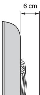
É necessária uma formação técnica adequada para instalar este produto, especialmente para determinar a resistência da parede para suportar o peso do televisor. Certifique-se de que a instalação deste produto na parede é efectuada por agentes da Sony ou contratantes licenciados por esta e preste atenção às medidas de segurança durante a instalação. A Sony não se responsabiliza por quaisquer danos ou ferimentos causados pela utilização indevida ou instalação incorrecta.
