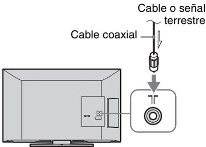
Conexión de una antena/cable/videograbadora/grabadora de DVD con SCART (euroconector)
