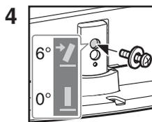
Insérez la vis dans le trou de vis supérieur du support de table.
