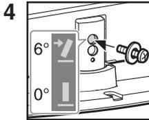
4 Plaats de schroef in de bovenste schroefopening van de tafelstandaard.
