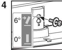
4 Schraube in oberes Schraubenloch am Tischständer schrauben.
