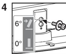
4 Installare la vite nel foro superiore del supporto da tavolo.
