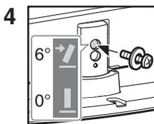
Instale o parafuso no orifício para parafuso superior do Suporte de fixação para mesas.
