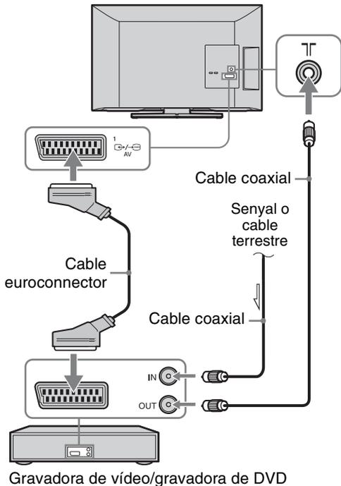
Connexió d'una antena/un cable/una gravadora de vídeo/una gravadora de DVD amb HDMI
