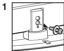
Retire o parafuso conforme indicado.
