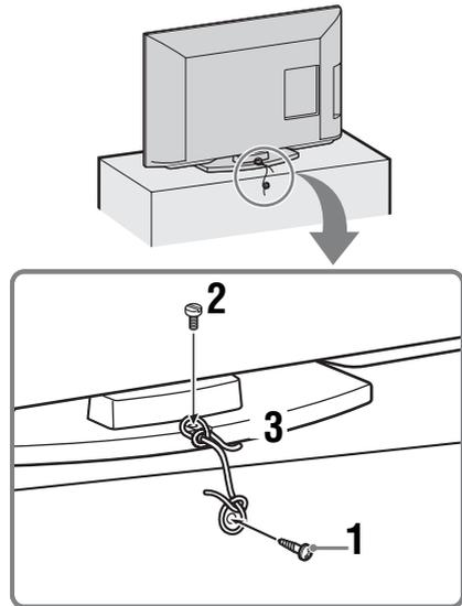
1 Schroef een houtschroef (4 mm diameter, niet bijgeleverd) in de televisiestandaard.
