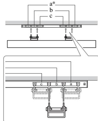
\* Plaats "a" van de haak kan niet worden gebruikt voor de modellen.
