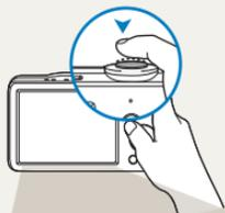
Halten Sie den **[Auslöser]** halb-gedrückt, um den Fokus anzupassen. Schärfte und Belichtungsstärke werden automatisch angepasst.
