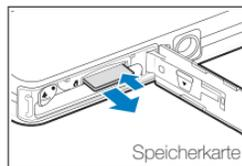
Drücken Sie vorsichtig gegen die Speicherkarte, so dass sie austrastet, und ziehen Sie sie dann aus dem Speicherkarteneinschub.
