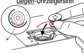
– Spule in Spulenkapsel einsetzen. Darauf achten, dass sich die Spule im **Gegen-Uhrzeigersinn** dreht (siehe auch Zeichnung unterhalb von Spulenkapsel)
