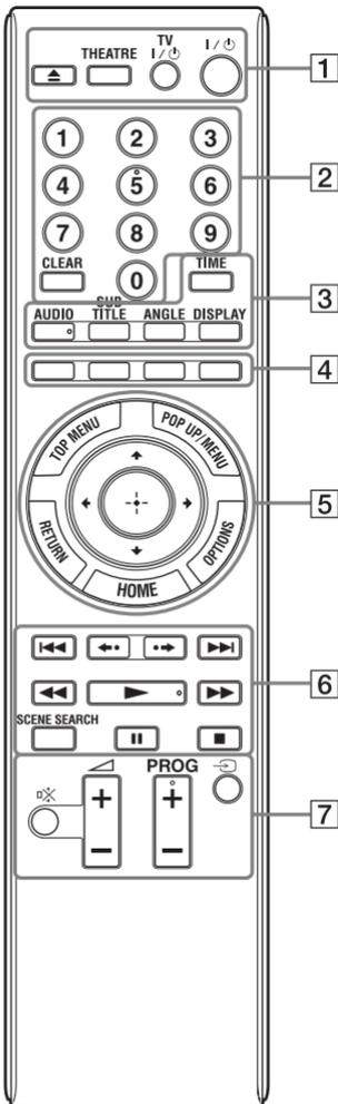
Die Zifferntaste 5 und die Tasten AUDIO, PROG + und ► sind mit einem Tastpunkt versehen. Benutzen Sie diesen Tastpunkt als Anhaltspunkt bei der Bedienung des Players.
