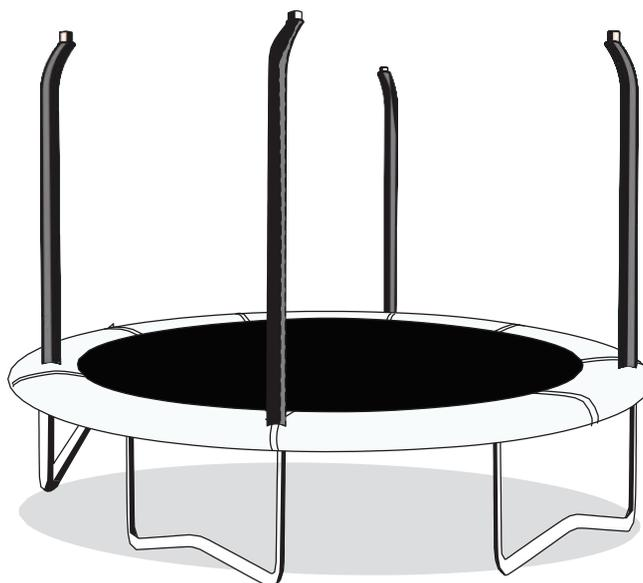
Procedere ora al montaggio della rete di recinzione. Stendere la rete (15) lungo il tappeto elastico, come mostrato in figura.
