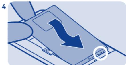
Alignez les contacts de la batterie et insérez-la en appuyant dessus.
