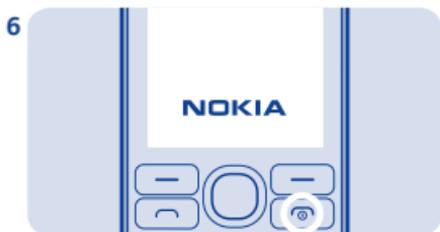
Pour mettre le téléphone sous tension, maintenez
