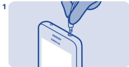
Connectez un kit oreillette compatible. Il fait office d'antenne.
