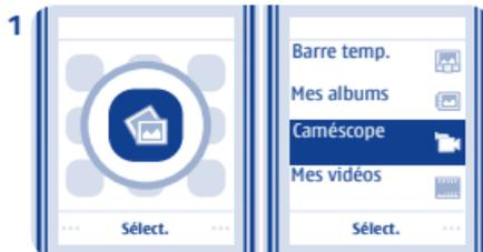
1 Pour ouvrir l'appareil photo, sélectionnez **Menu > Photos > Caméscope**.
