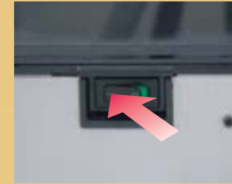
Zum Einschalten der Maschine Schalter auf „I“ stellen.
