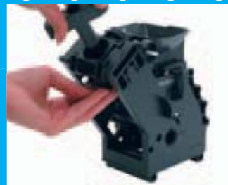
Remonter le filtre après l'avoir nettoyé.
