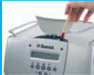
Mit der Bürste die Pulverkaffee-Dosiervorrichtung reinigen.
