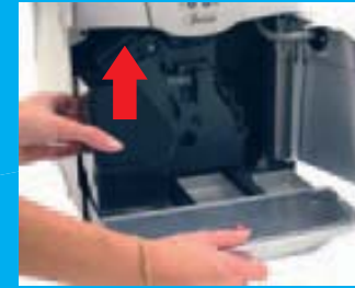
Kaffeesatzbehälter herausnehmen, entleeren und reinigen.
