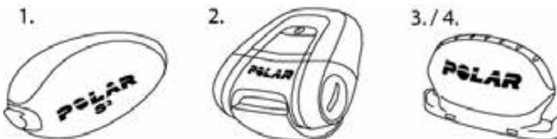
1. Sensore Polar s3 stride sensor™ W.I.N.D.: trasmette i dati relativi alla distanza percorsa e alla velocità/andatura di corsa al training computer. È inoltre in grado di calcolare la cadenza della corsa e la lunghezza della falcata.
