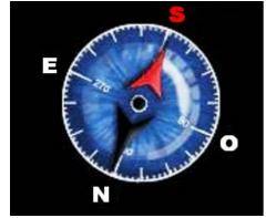
Anmerkung; Zur Sicherstellung einer genauen Ablesung am Kompass, achten Sie bei der Ablesung bitte darauf, sich nicht in der Nähe von großen Metallobjekten zu befinden, insbesondere Elektrokabeln, und führen Sie außerdem die Ablesung mehrfach durch.
